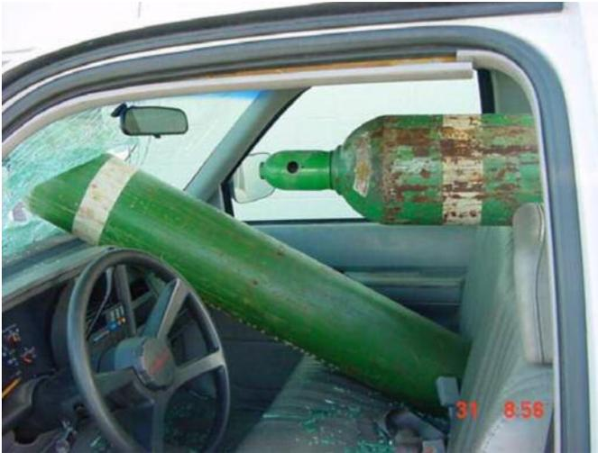
Vor dem Verstauen der Druckgasflaschen im PKW prüfen, dass die Ventile dicht geschlossen sind.
