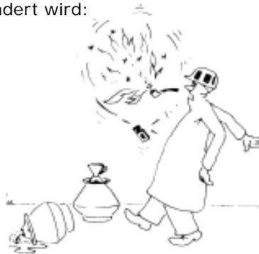
Eine Sauerstoffanreicherung der Luft von (normal) 21 Vol.-% auf mehr als ca. 23 Vol.-% erhöht die **Brandgefahr** erheblich. Tiefkalt verflüssigter Sauerstoff gehört daher nicht in offene Gefäße.
