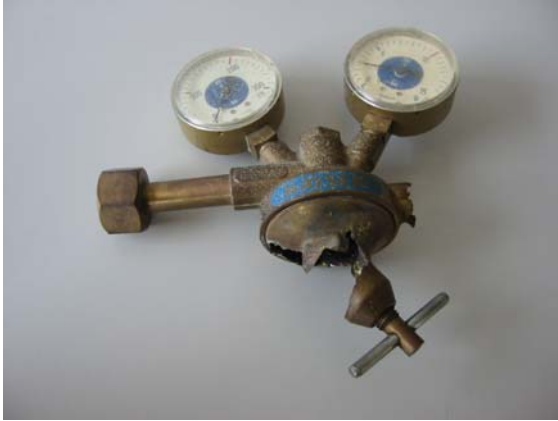
Bilder 3 und 4 ausgebrannte Druckminderer
