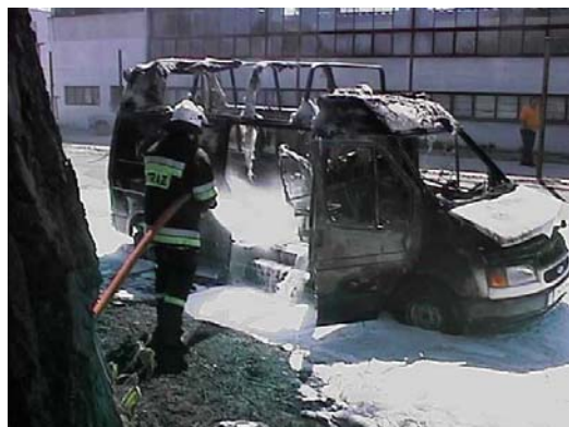
Eine undichte Acetylenflasche brannte am Ventilauslass. Der Fahrer entkam knapp und der Van brannte in zwei Minuten aus.
